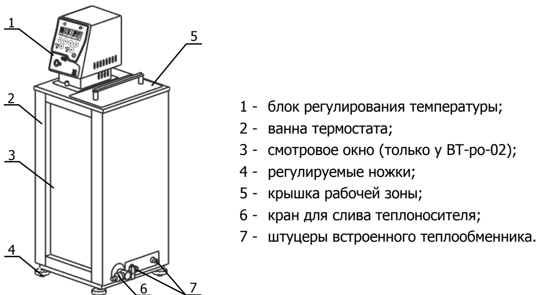
Рисунок 1 — Устройство термостата ВТ-ро-02
